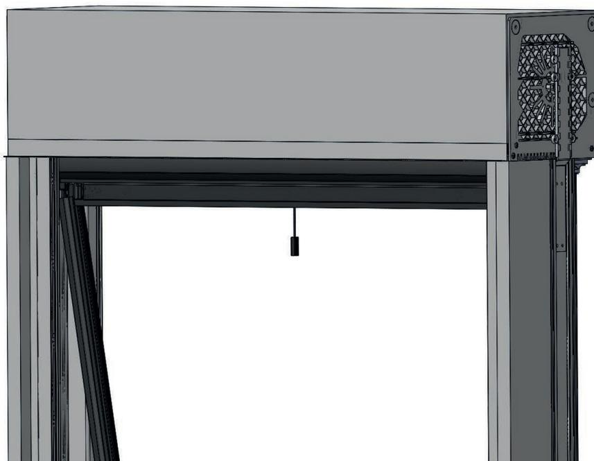
Fixation sur le cadre en utilisant **deux vis par côté**, une en haut et une en bas.
