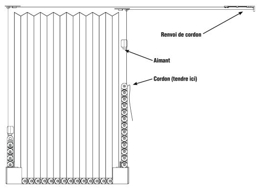
Fermer le kit de modèle plissé. Desserrer la vis sur le maillon blanc de la chaîne **②** , tendre légèrement le cordon en tirant dessus **③** et resserrer la vis **④** . Raccourcir le cordon à environ 20 cm.
