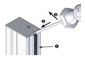
Aligner la toile plissée sur les clips de fixation en bas puis en haut 4 (l'insérer en haut dans le profilé de caisson) et l'emboîter en poussant avec précaution.
