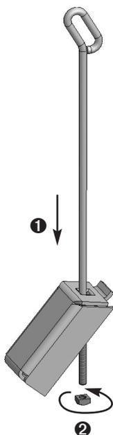
👉 Le serrage de l'écrou doit être tel que le boîtier ne se bloque pas une fois fermé et que la tige de sécurité n'ait pas de jeu.
