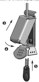
Le serrage de l'écrou doit être tel que le boîtier ne se bloque pas une fois fermé et que la tige de sécurité n'ait pas de jeu.
