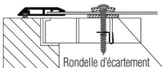
Pour réduire le blanchiment de la toile, des rondelles d'écartement doivent être montées entre la toile V2A et la grille galvanisée.
