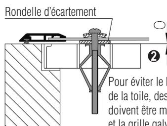
Pour éviter le blanchiment de la toile, des rondelles d'écartement doivent être montées entre la toile V2A et la grille galvanisée.
