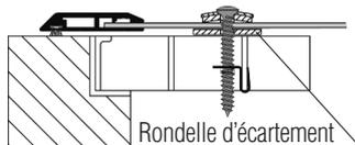
Pour réduire le blanchiment de la toile, des rondelles d'écartement doivent être montées entre la toile V2A et la grille galvanisée.
