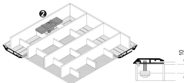
**Attention :** si la hauteur des baguettes supports varie, utiliser des vis en acier inoxydable plus courtes ou plus longues, selon le cas !
