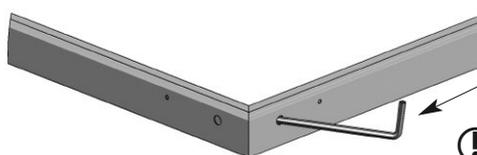
Serrer alternativement à gauche et à droite avec la clé Allen de 2,5 mm.
