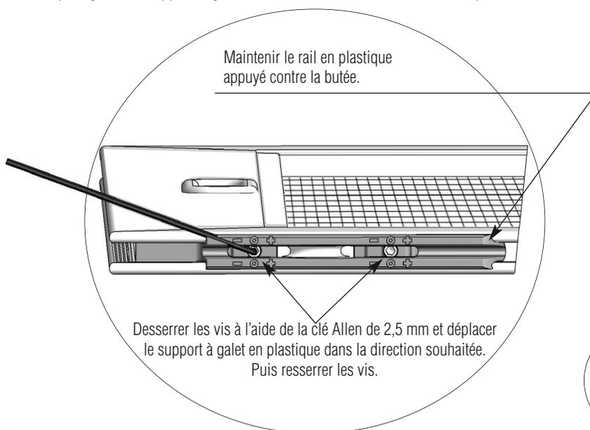
Desserrer les vis à l'aide de la clé Allen de 2,5 mm et déplacer le support à galet en plastique dans la direction souhaitée. Puis resserrer les vis.
