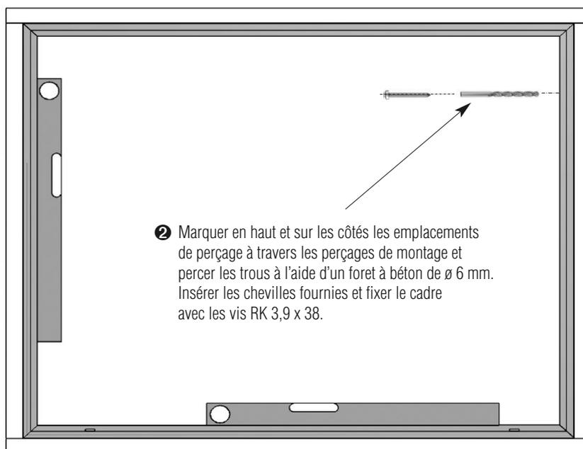
2 Marquer en haut et sur les côtés les emplacements de perçage à travers les perçages de montage et percer les trous à l'aide d'un foret à béton de  $\varnothing 6$  mm. Insérer les chevilles fournies et fixer le cadre avec les vis RK 3,9 x 38.
