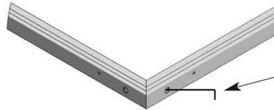
Serrer alternativement à gauche et à droite avec la clé Allen.
