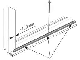
Marquer les emplacements de perçage à travers les orifices de montage et percer les trous à l'aide d'un foret à béton de  $\emptyset$  6 mm. Insérer les chevilles fournies et fixer le rail de guidage avec les vis SK 3,5 x 40
