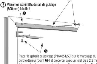
bord extérieur (point ②) et prépercer avec un foret de  $\emptyset$  2,2 mm à travers les deux canons de guidage extérieurs pour fixer l'arrêt du vantail coulissant et l'équerre. Fixer ces pièces avec les vis SK 2,9 x 9,5.
