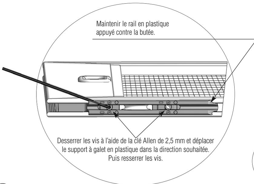
Desserrer les vis à l'aide de la clé Allen de 2,5 mm et déplacer
