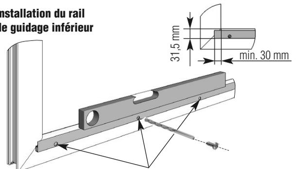
Prépercer les trous de montage et fixer le rail de guidage avec les vis RK 3,5 x 13.
