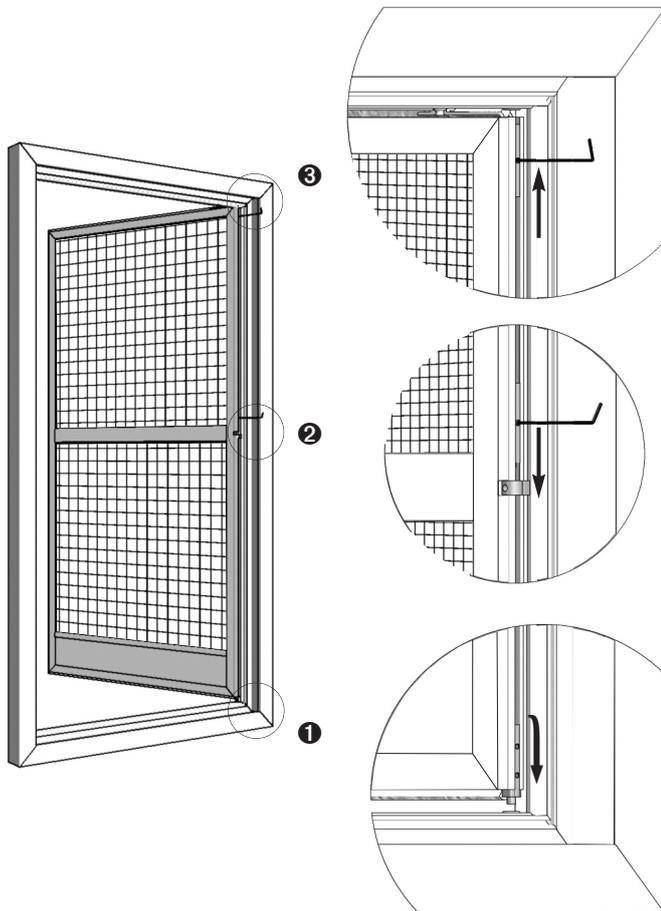
1 Insérer le cadre pivotant tel qu'illustré dans la figure en glissant le tenon inférieur dans la mortaise, 2 ajuster à la charnière du milieu, pousser la pièce de serrage dans la charnière et la serrer avec la clé Allen fournie avec la moustiquaire. 3 Insérer la charnière du haut au maximum dans la mortaise avec la clé Allen fournie avec la moustiquaire et la serrer à fond.
