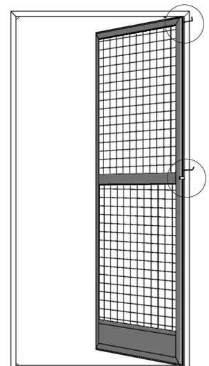
Dans le cas de l'option « perçages de montage latéraux », retirer les joints-brosses du cadre de montage.
