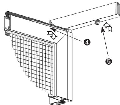
Vérifier que la distance du cadre pivotant par rapport au cadre de montage est la même sur tout le tour (6 mm). Si nécessaire, ajuster le cadre de montage.
